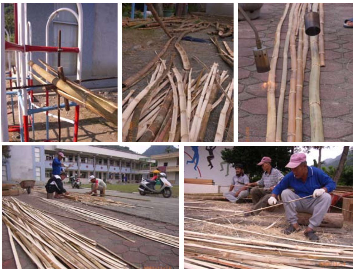
圖36-40，火烤竹片使水分蒸發，增強耐久性與防蟲。削薄竹片是耗時的工作，但能讓編製過程滑順，精緻美觀；在設計者的堅持下，製作團隊只好耐著性子繼續處理。
